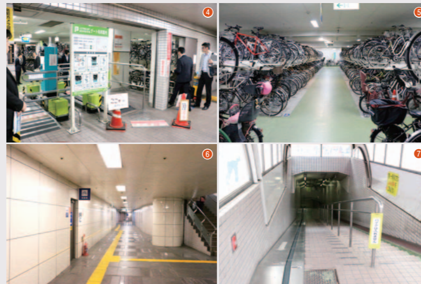
④北口地下自転車駐車場。自動ゲートは交通系電子マネーに対応。⑤2段式ラックにより1080台を収容。⑥駐輪後は地上へ出ずに地下通路で駅へ。⑦スロープはベルトコンベア付き
