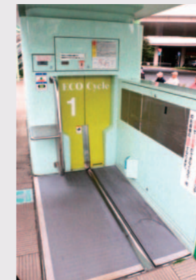
南口の地下タワー式自転車駐車場「エコサイクル」。ロータリーを囲むように6基設置されている。平均出庫時間は約13秒と非常に早い
