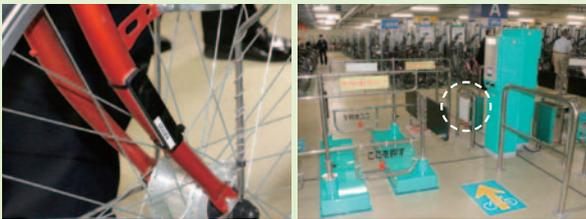
フロントフォークのタグにより、ゲートは自動で開閉する
